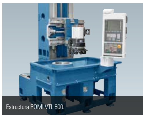
Torre tipo T, servoaccionada para 12 herramientas fijas.
