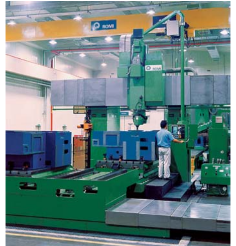
El mecanizado de acabado de las máquinas herramienta Romi se realizan en equipos de gran capacidad y de alta precisión.
