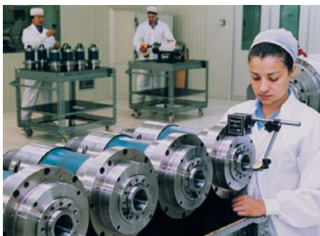
Los cartuchos de los husillos son ensamblados en una sala ultra-limpia, dónde la temperatura, la humedad relativa del aire y la cantidad de partículas en suspensión están controladas.
